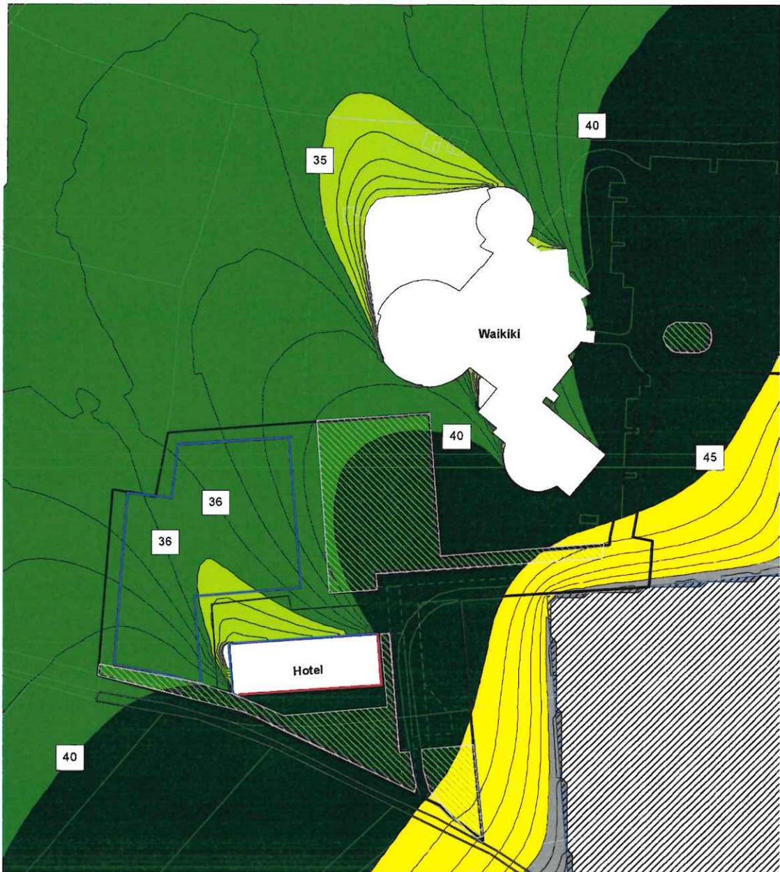
Abbildung 5: Beurteilungspegel Nacht in dB(A) in Höhe Erdgeschoss durch gewerbliche Anlagen
