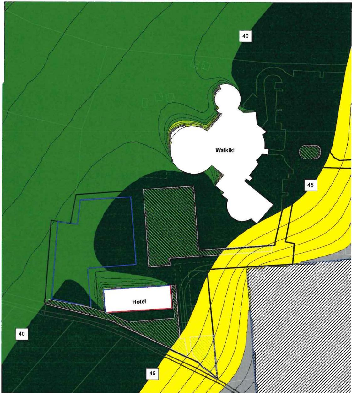
Abbildung 7: Beurteilungspegel Nacht in dB(A) in Höhe 2. Obergeschoss durch gewerbliche Anlagen
